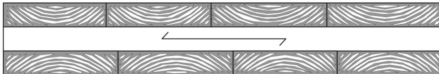
**Bild 3:** Grundsätzlicher Aufbau eines 5-lagigen Brettspertholzes
